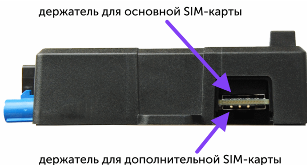
Рис. 3.2. Расположение основной и дополнительной SIM-карты.
