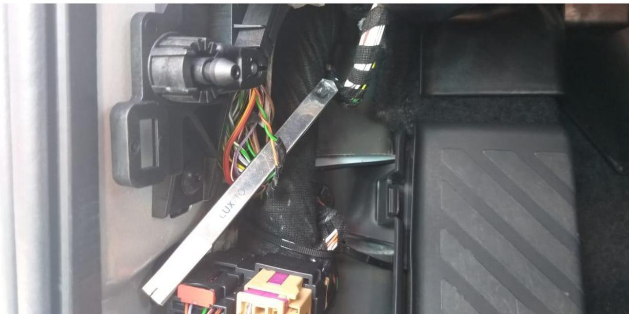
Подключение CAN2: на диагностическом разъеме OBD-II.
